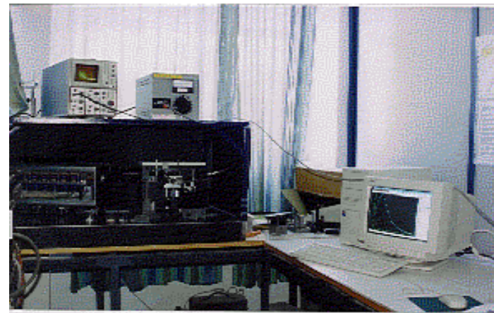
Φασματοσκοπία του laser επαγόμενου φθορισμού με φασματογράφο και συστοιχία φωτοδιόδων.
